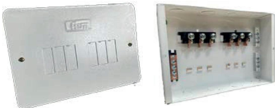
Construidas en lámina de acero COLDROLLED calibre 24 (0.55 mm). Con tratamiento de limpieza, desengrasado, fosfatizado y pintura electrostática en polvo tipo poliéster para exteriores color RAL 9003, espesor mayor a A 65 µm.
