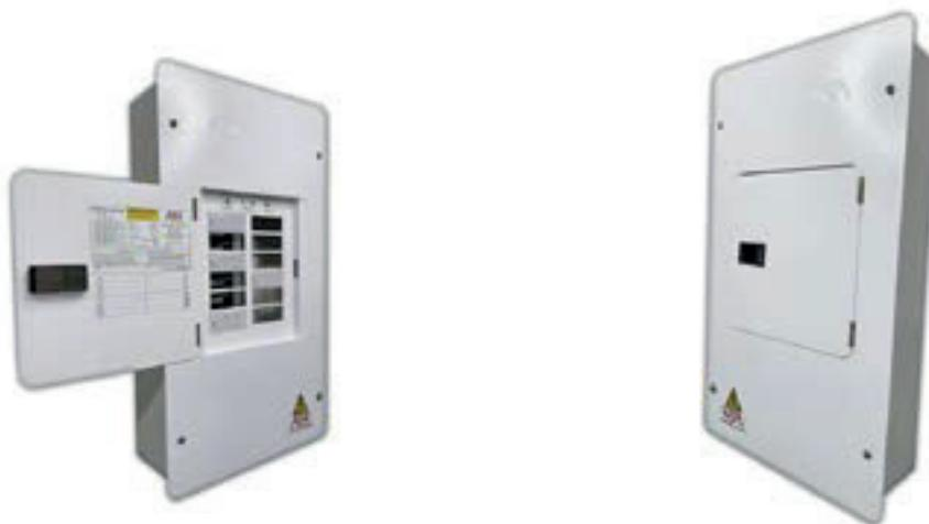
Construidas en lámina de acero COLD ROLLED CALIBRE 18 (1.1mm). Con tratamiento de limpieza, desengrasado, fosfatizado y pintura electros - tática en polvo, tipo poliéster para exteriores color blanco RAL 9003, espesor mayor a 65 µm.
