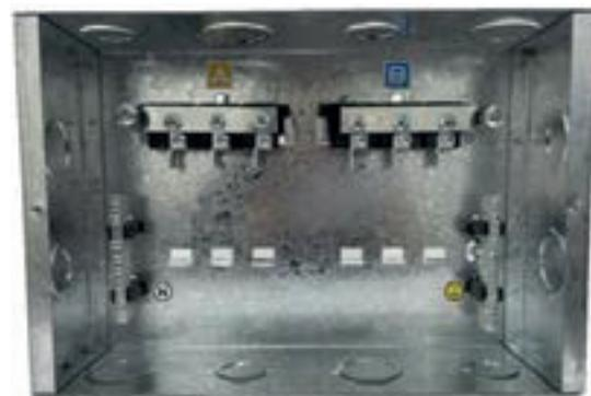
Construidas en lámina de acero COLD ROLLED CALIBRE 18 (1.1mm). Con tratamiento de limpieza, desengrasado, fosfatizado y pintura electros-táctica en polvo, tipo poliéster para exteriores color blanco RAL 9003, espesor mayor a 65 µm.
