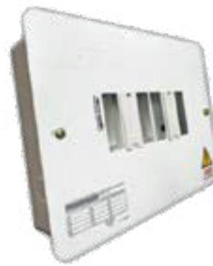
Construidas en lámina de acero COLD ROLLED CALIBRE 20 (0.85mm). Con tratamiento de limpieza, desengrasado, fosfatizado y pintura electrostática en polvo, tipo poliéster para exteriores color blanco RAL 9003, espesor mayor a 65  $\mu$ m.
